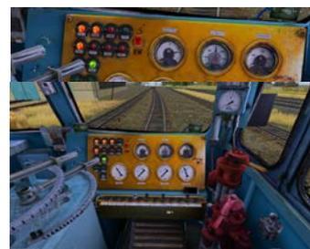
Далее поднимается два тумблера токоприемники и токоприемник 1 следует убедиться, что токоприемник поднят. После подъема токоприемника прибор измерения напряжения контактной сети укажет напряжение.
