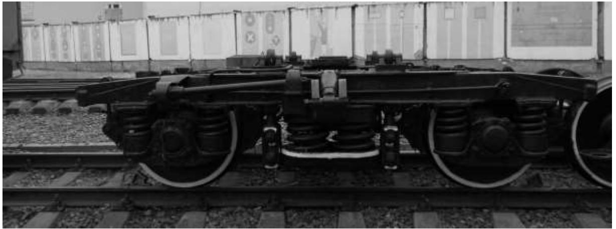
Фото 12 – Двухосная тележка пассажирского вагона
