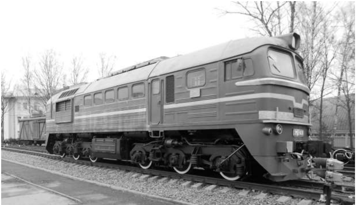
Фото 2 – секция тепловоза 2М62
